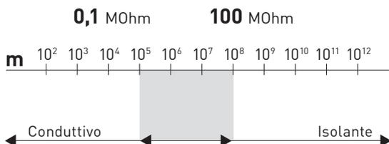
Il campione esaminato soddisfa quanto prescritto dalle norme CEI EN 61340-5-1:2016/ COR1:2017, CEI EN IEC 61340-4-5:2018 e CEI EN IEC 61340-4-3:2018 relativamente ai requisiti per gli elementi specifici di protezione dalle ESD di componenti elettronici (campo di applicazione relativo alla produzione ed all'utilizzo di dispositivi elettronici).
